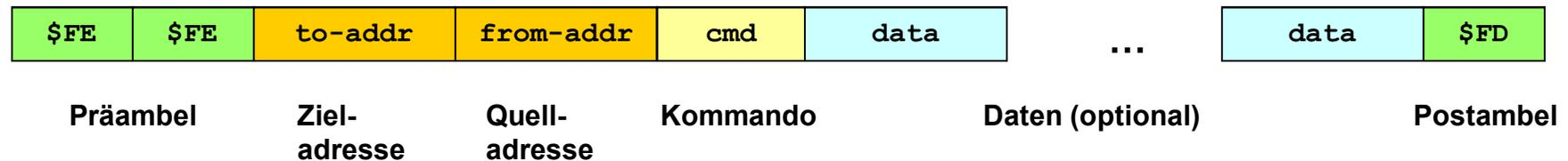
Das Bild zeigt den prinzipiellen Aufbau eines CI-V – Telegramms.
