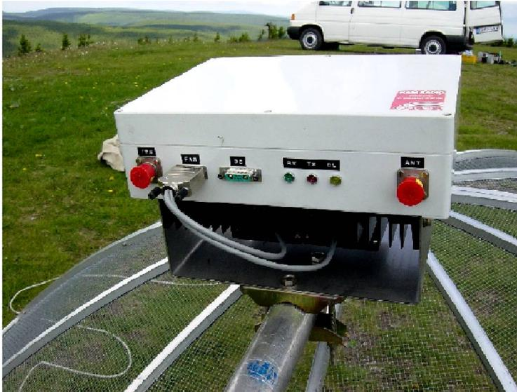
Im Bild links unsere 80W – Modul – PA für 23cm (nach DL2AM). In dieser Leistungsklasse ist es noch möglich, die Stromversorgung aus dem Shack heraus zu betreiben. Wir verwenden dafür eine 15m lange 16mm<sup>2</sup> - Cu – Leitung, um bei 14,5V bis zu 20A bereitzustellen. Die Überwachung der PA erfolgt durch Kontrolle der Stromanzeige am Netzteil sowie LEDs am Mastgehäuse, die von unten noch gut zu sehen sind.
