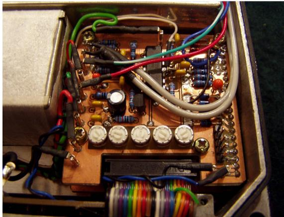
Zur Zeit zwar ohne Telemetrie, dafür mit örtlicher Anzeige: im 24GHz – Transverter findet sich die gleiche Schaltungskonzeption wieder. Aus Platzgründen kommt hier allerdings eine Sandwichbauweise zum Tragen. Die Mikrocontrollerplatine befindet sich unten, gefolgt von der Analogplatine mit den Anschlüssen für die Sensoren. Links unten im Bild ist die senkrechte Anzeigeplatine zu sehen.
